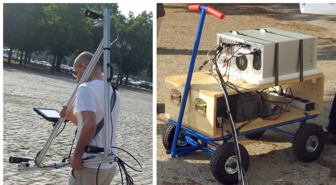
Abbildung 10: Kamerasystem mit Rahmen und Touchscreen und Aufnahmerechner
