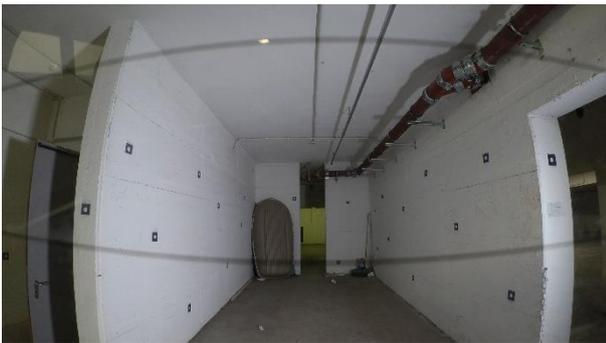
Photogrammetrie bedeutet *Messen in Bildern*. Zur korrekten Durchführung von Bildmessungen ist es notwendig, dass die innere Orientierung bekannt ist und die verwendeten Bilder frei von optischen Abbildungsfehlern sind. Typische Abbildungsfehler sind Verzerrungen, wodurch zum Beispiel Geraden in der Realität im Bild gekrümmt dargestellt werden. Zur Bestimmung der inneren Orientierung und von Parametern zur Korrektur
