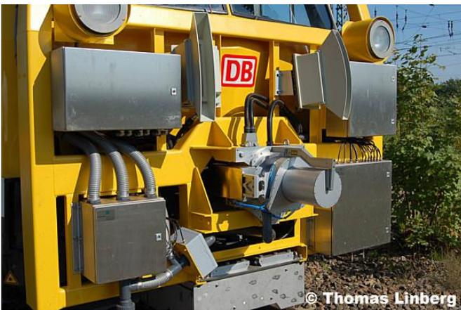
Die Messzüge der Deutschen Bahn AG ermöglichen eine kinematische Echtzeitbestimmung von fahrbahndynamischen Eigenschaften und Positionen die mit Hilfe gängiger Messverfahren und moderner Sensortechnik metergenau lokalisiert werden können. Diese charakteristischen Eigenschaften der Fahrbahn lassen entsprechende Aussagen über Störstellen und die tatsächliche Fahrdynamik des Schienenverkehrs zu. Alle erfassten Daten dieses Systems dienen der Deutschen Bahn
