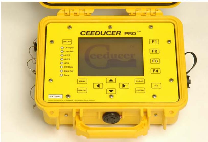
Echolotmessungen sind ein Standardverfahren für unterschiedliche Aufgaben der Seevermessung, z.B. in den Bereichen Fahrrinnenvermessung, Nassbaggerei, Kabel- und Pipelineverlegung. Die Positionierung des Echolots geschieht heute nahezu ausschließlich mittels GPS.
