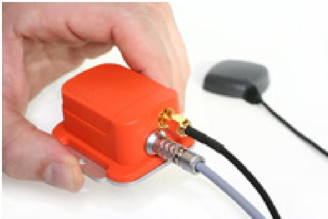
Seit neuestem besitzt das IAPG ein kleines Inertialnavigationsgerät, welches mit verschiedenen Sensoren ausgestattet ist, welche Position, Orientierung, Beschleunigung und Rotation messen können. Es sollen erste Experimente mit diesem Gerät durchgeführt werden, um dessen Eigenschaften zu charakterisieren, z.B. die Driftraten der Beschleunigungsmesser. Hierzu können kontrollierte Experimente mit einem Drehteller oder einer Modelleisenbahn durchgeführt
