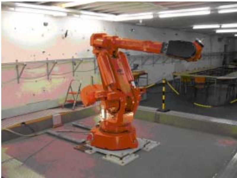
Das Geodätische Prüflabor des Lehrstuhls für Geodäsie verfügt seit 2007 über einen ABB-Industrieroboter, der sowohl für Geräteuntersuchungen und Instrumentenkalibrierungen als auch zur studentischen Ausbildung genutzt wird. Bis-her wurde der Roboter rein im „Teach-In-Modus“ betrieben. Dies bedeutet, dass der Roboter in einer Lernphase mittels Joystick manuell an seine Zielpunkte verfahren und die kinematischen Parameter der Bewegung am Steuergerät
