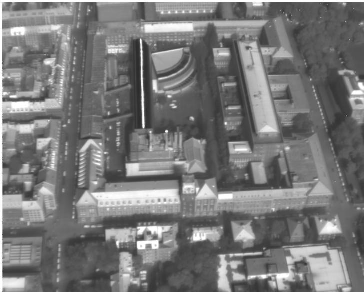
Thermale Bilddaten werden heute in unterschiedlichen Maßstäben und für die verschiedensten Anwendungszwecke eingesetzt. Unser aktuelles Forschungsprojekt befasst sich mit der Texturierung von 3D-Gebäudemodellen im Infrarotspektrum. Nicht alle Teile eines Gebäudes können vom Boden aus aufgenommen werden. Luftaufnahmen dienen zur Erfassung von Dächern und Teilen von Fassaden in nicht zugänglichen Bereichen. Dazu muss das gegebene untexturierte Gebäudemodell in die Bilder der Infrarot-
