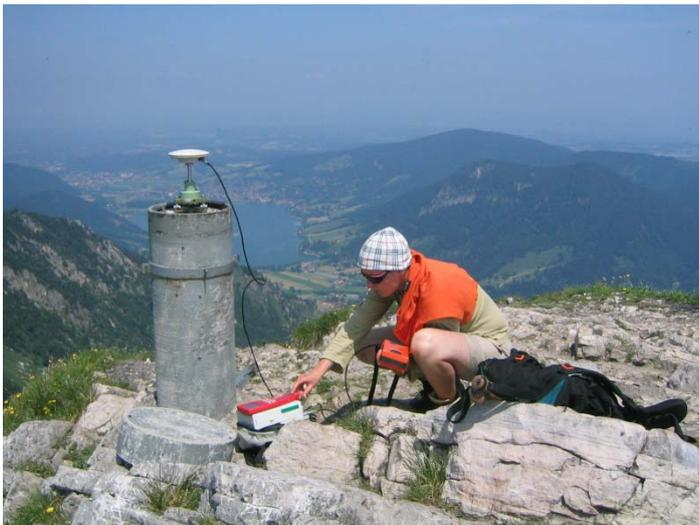
Großflächige Netzmessungen höchster Präzision finden hauptsächlich Anwendung für infrastrukturelle Ingenieursbauten wie Tunnelportalnetze, Brücken- und Stollennetze, Netze für Sperrerbauwerke usw. Nicht selten sind diese Netze in bergigem und geologisch aktivem Gelände anzulegen. Für die Netzanlage kommen GNSS, TPS oder hybride Ansätze in Betracht. Gerade bei großen Höhenunterschieden reichen jedoch die Standard-Modellierungen
