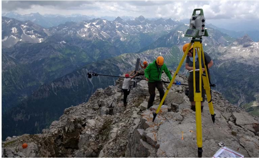
Abb.3: Datenaufnahme in die Hauptspalte mit auf Hochstativ montierter Kamera. Es wird davon ausgegangen, dass sich der südöstliche Teil, auf dem sich die Messkugeln (rechtes Bild) befinden, vom stabilen nordwestlichen Teil mit dem Gipfelkreuz (linkes Bild) entfernt. Eine Datenaufnahme ist nur vom nordwestlichen Teil möglich.
