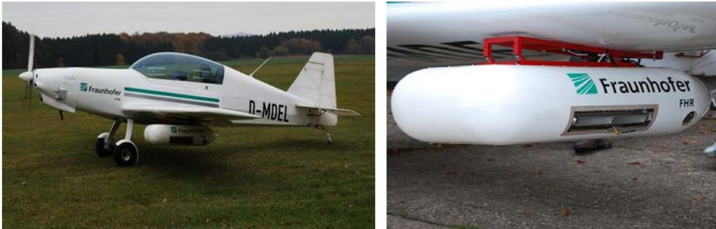
Abb. 2: Ultraleichtflugzeug DELPHIN mit eingebautem Sensor MIRANDA35.
