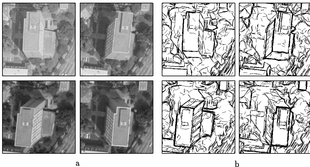
Abb. 3-8: a) Verschiedene Ansichten eines Hochhauses und b) detektierte Kanten [112]
