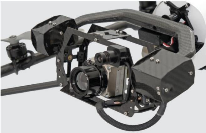
Das Fachgebiet Photogrammetrie und Fernerkundung verfügt über ein RPAS (Remotely Piloted Aircraft System) das bereits erfolgreich für fachübergreifende Projekte z.B. in der Archäologie eingesetzt wurde. Das RPAS ist derzeit mit einer RGB Kamera (Sony NEX -7) ausgestattet, die im Rahmen eines Vertiefungsprojektes kalibriert wurde. Im Zuge einer Erweiterung der Sensoreigenschaften wurde Anfang des Jahres die Thermalkamera (Flir Tau 640) mit guter thermi-
