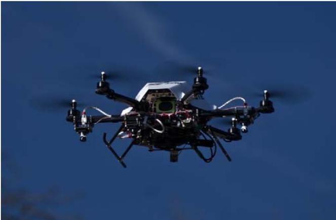
Der Lehrstuhl für Methodik der Fernerkundung und das Fachgebiet für Photogrammetrie und Fernerkundung haben ein Asctec Firefly UAV angeschafft. Das UAV ist mit einem Onboardcomputer und einem Kamerasystem ausgestattet. Der Onboardcomputer erlaubt die automatische Aufnahme von Bilddaten, sowie eine direkte Prozessierung dieser. Die Onboard-Bildprozessierung soll zur automatischen Steuerung sowie zur Hinderniserkennung dienen. Das Kamera-
