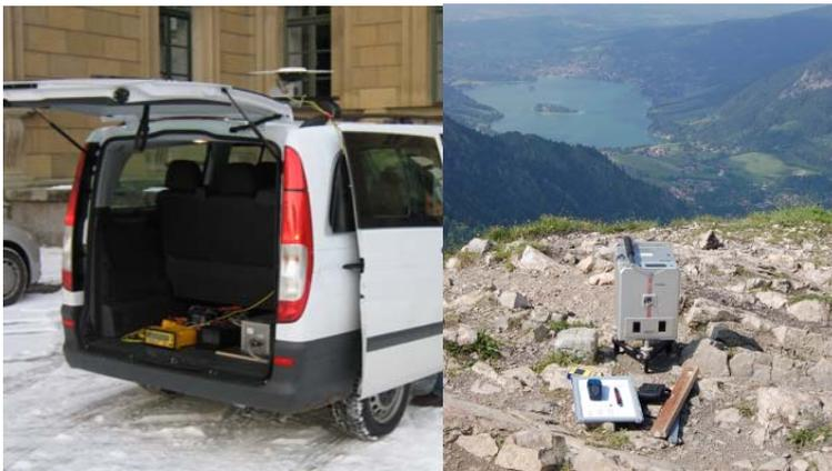
Lokale Schwerefeldinformation kann aus einer Kombination von Messungen eines hochgenauen inertialen Messsystems (IMS) und parallel zu tätigen GPS-Beobachtungen ermittelt werden. Diese Vorgehensweise ist bekannt und wird in der Fluggravimetrie eingesetzt. In einem Experiment soll dieses Verfahren terrestrisch erprobt werden.
