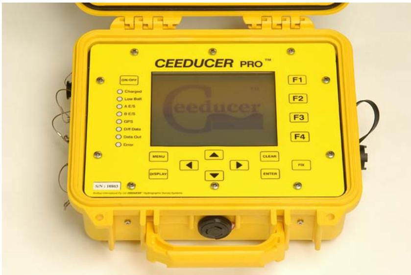
Echolotmessungen sind ein Standardverfahren für unterschiedliche Aufgaben der Seevermessung, z.B. in den Bereichen Fahrtrinnenvermessung, Nassbaggerei, Kabel- und Pipelineverlegung. Die Positionierung des Echolots geschieht heute nahezu ausschließlich mittels GPS.
