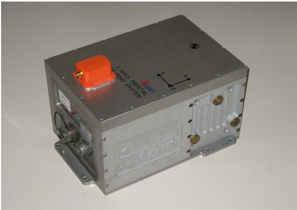
Abbildung 1: IMU iNAV-RQH von IMAR und MTi-G von Xsens (orange)
